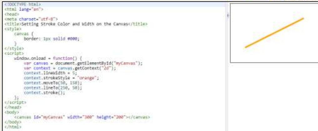
Εικόνα 86 – Ρύθμιση των στυλ και των χρωμάτων σχεδίασης χρησιμοποιώντας τις ιδιότητες strokeStyle και lineWidth (Πηγή: https://www.tutorialrepublic.com/html-tutorial/html5-new-input-types.php )
