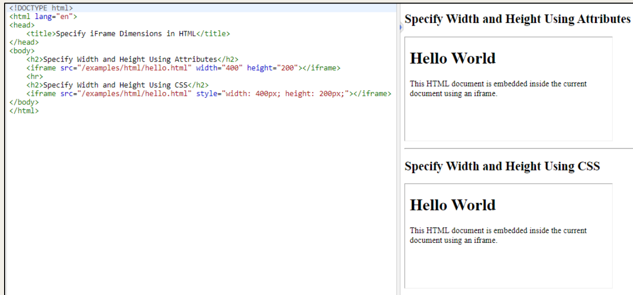
Εικόνα 60 – Κωδικός για τη ρύθμιση ύψους και πλάτους ενός inline frame (Πηγή: Συγγραφέας)
